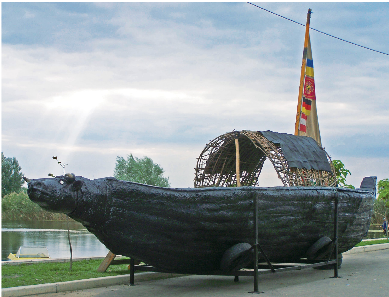
Реконструкція каркасної набійної лодки «Меотида». Лодка побудована у 2003 році для експериментальних походів по річках України та Азовському морі, випробувана на річці Дністер.
